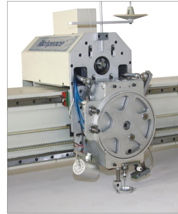
Cabeçote de costura com calcador ajustável para diferentes espessuras de materiais até 70mm.
